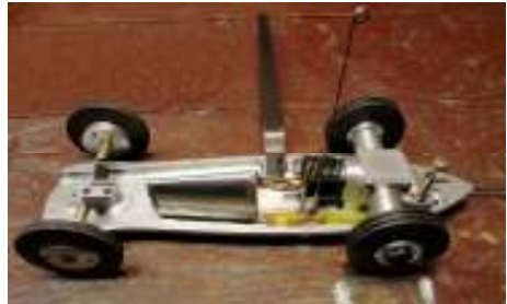
Telaio completo di tutte le parti meccaniche. L'astina verticale comanda lo spegnimento.
