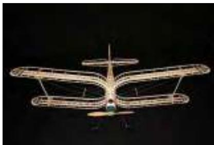
controllato/disturbato a due assi, di 140 cm di apertura per l'ala superiore e 120 cm per quella inferiore (proiezioni in pianta) decalate di 3 cm. Il profilo adottato è, come nell' originale, il NACA 23009 con corda di 18cm. per l'ala superiore e 15 per quella inferiore.
