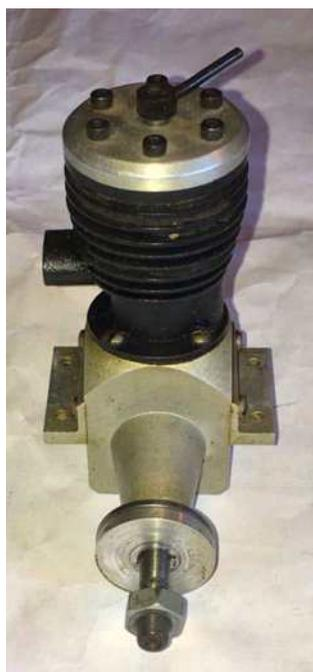
Sia come sia, la “traduzione” ha generato misure leggermente diverse: alesaggio 17 mm e corsa 18.2 mm. quindi la cilindrata è di 4.13 cc che è molto vicino alla cilindrata di un .25.
