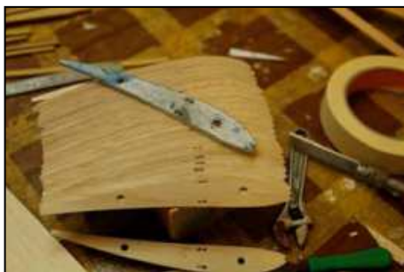
Tecniche costruttive rigorosamente Old Timer. Centine ritagliate una per una e poi rifinite a pacchetto
