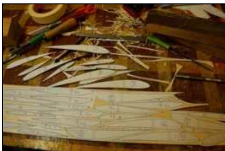
Tecniche costruttive rigorosamente Old Timer. Centine ritagliate una per una e poi rifinite a pacchetto
