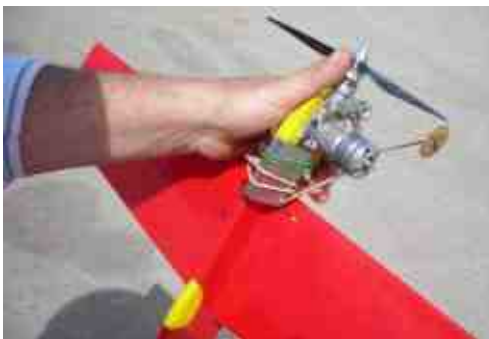
Particolare del modello di Pietro Maugeri Degni di nota il venturi e la prolunga sull'albero
