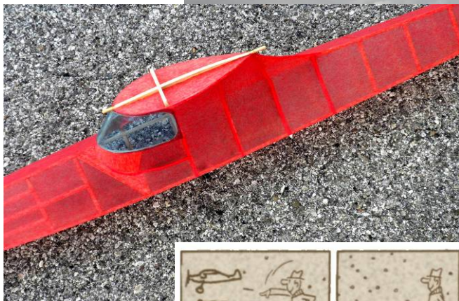
▲ - Le parti di un Wakefield inglese del 1950 realizzate da Canestraro; il tritico disegnato da Reg Parham ◀ con il relativo dimensionamento (in pollici) e opportunamente rivisitato
