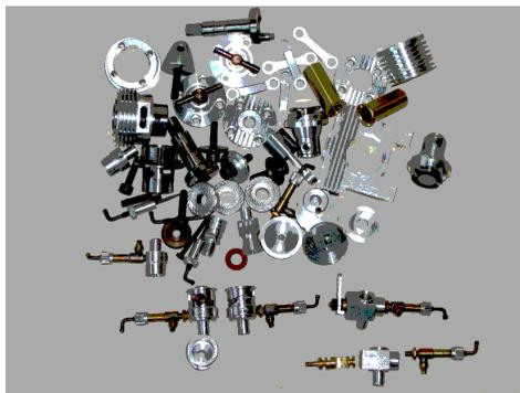
*Vari pezzi tra cui un impianto scarico per il bicilindrico ed in basso dei carburatori rc*
