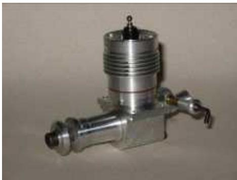
Motori maggiorati sia nel diametro dell'albero che nella cilindrata ottenendo così un motore da c.c. 1,65 più pesante del precedente ma più potente
