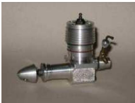
*Motore monocilindrico da 1,5 c.c. glow, realizzato con membrana vibrante, ha i travasi realizzati con condotti fresati che ricordano il cilindro del Supertigre G 27 D a luci incrociate*
