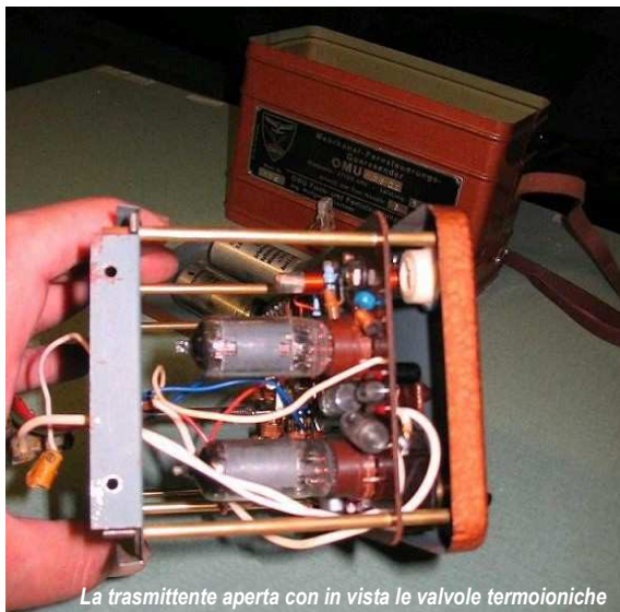
La trasmittente aperta con in vista le valvole termoioniche
