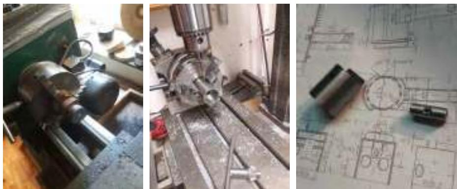
La ghisa mehanite per il pistone è ricavata da un albero a cammes di un motorhome di 40 anni fa. Alla prima stroncatura segue lo svuotamento del pistone e l'esecuzione del foro guida per il futuro spinotto. L'ultima immagine mostra lo sbizzato del pistone ed il cavallino interno.
